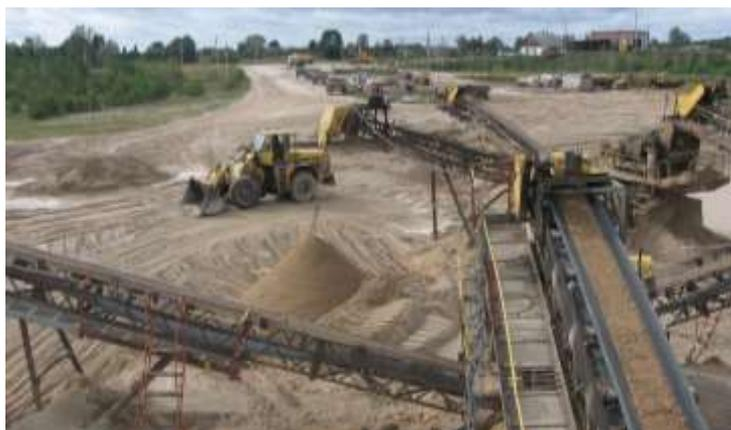
Дальше песок перевозят к дробильно-сортировочной установке, где его просеивают. Затем большегрузные машины отвозят песок на погрузочную площадку, загружают в вагоны и отправляют по назначению. Сеяный песок используется в строительных целях, а гравийная смесь для ремонта и строительства дорог. Песок и гравийно-песчаные смеси полностью удовлетворяют потребности Витебской области, а также поставляются в Могилёвскую область.
